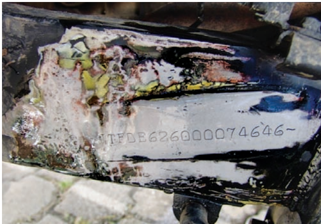
Serie de chasis cuyo método de alteración es por injerto metálico, sobre la base de la rama del chasis de un vehículo investigado.
