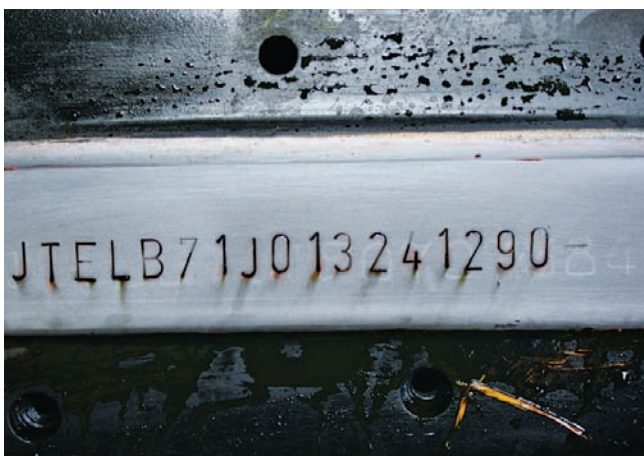
Serie de chasis alterada y restaurada la original de un vehículo robado.
